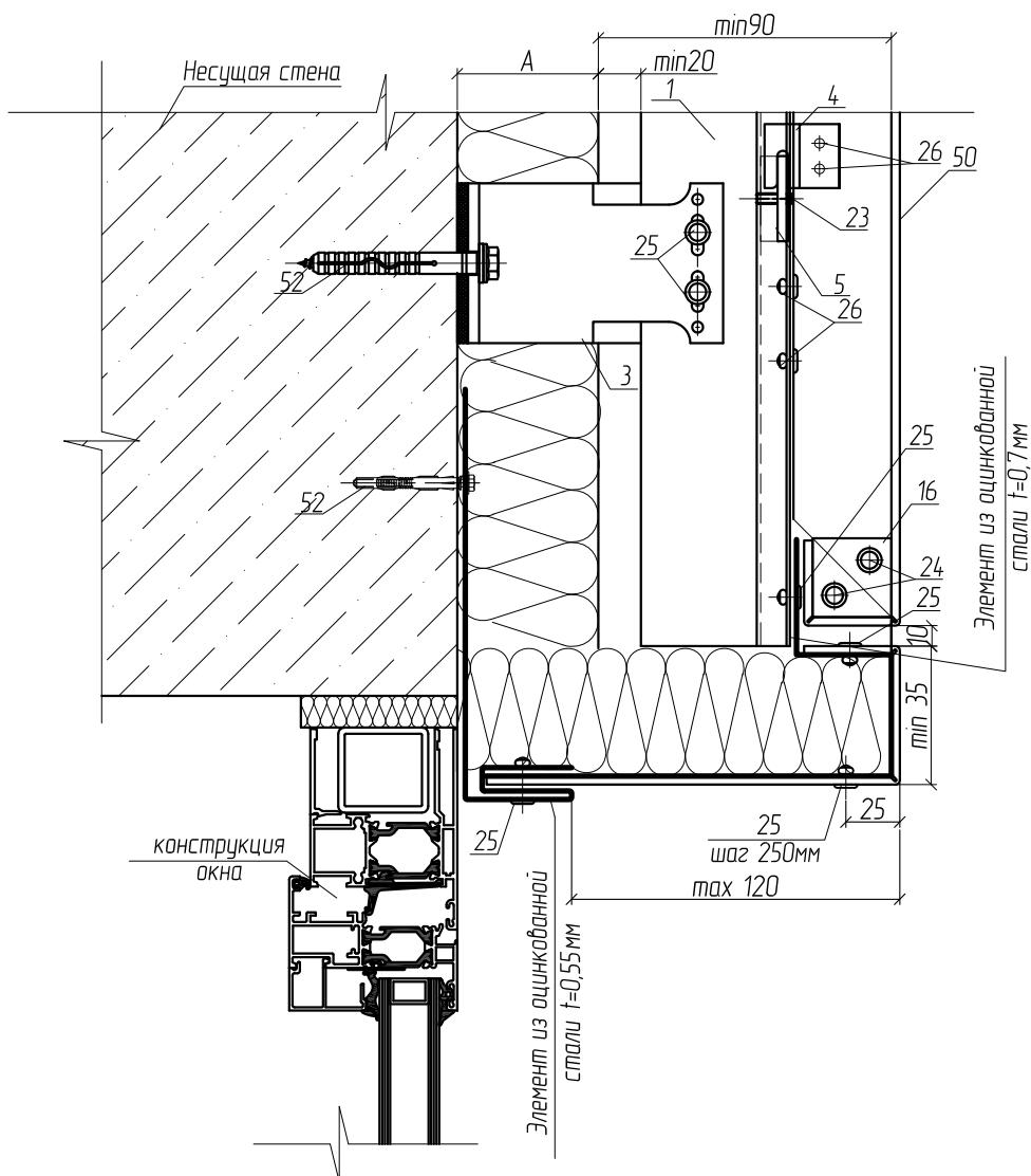
**8.8.3. Узел примыкания к верхней части оконного проема
