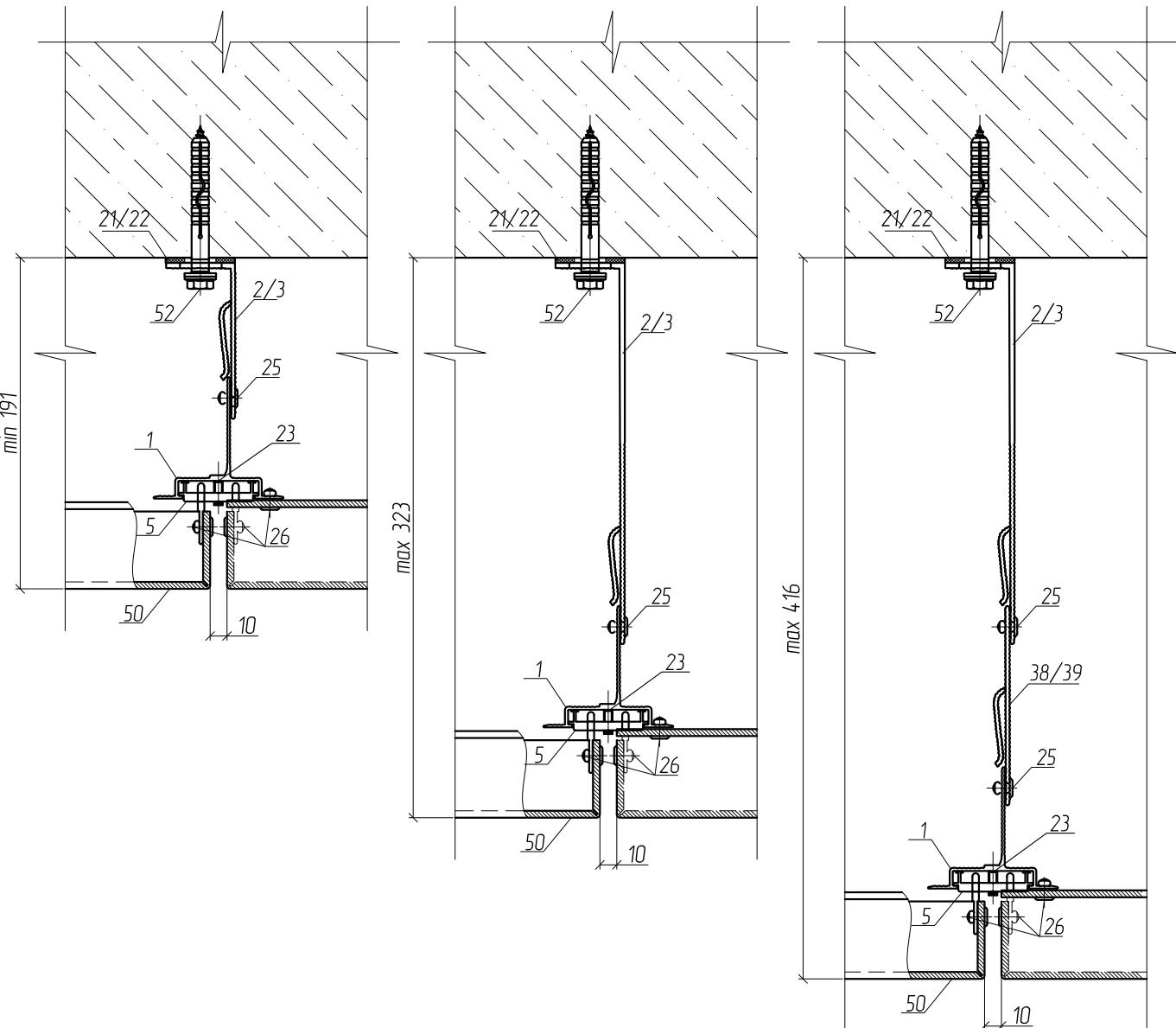
**7.3.3. Варианты установки системы с различным относом от стены.
