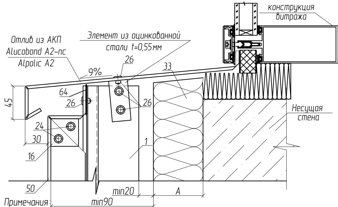
\*-установка оконного блока в проем производится в соответствии с ГОСТ 30971-2002 "Швы монтажные узлы примыканий оконных блоков к стеновым проемам".
