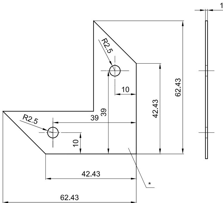
\*-возможно изготовление из нержавеющей стали
