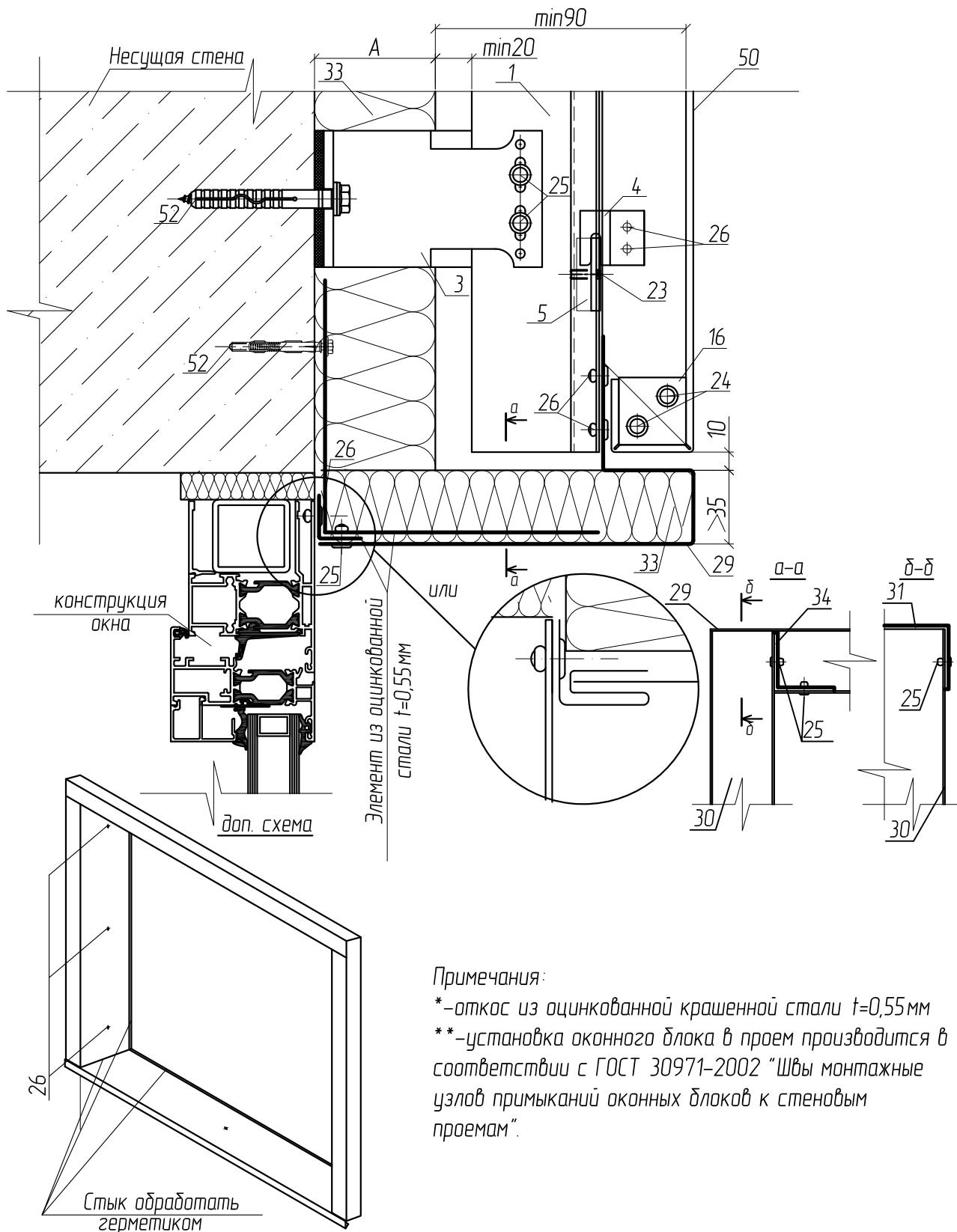
**8.8.2. Узел примыкания к верхней части оконного проема
